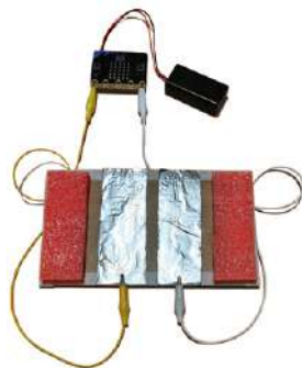
Figura 2: Para armar el circuito, se coloca un cable cocodrilo en el PIN 0 de la micro:bit y otro en GND. Los cables se vinculan luego al cartón inferior, pinzando por separado las franjas con aluminio (el circuito se encuentra abierto , ya que las franjas no están en contacto).
