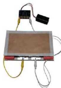
Figura 3: Circuito finalizado. Cuando se ejerce presión, el papel aluminio del cartón superior toca las franjas de papel aluminio del cartón inferior cerrando el circuito.
